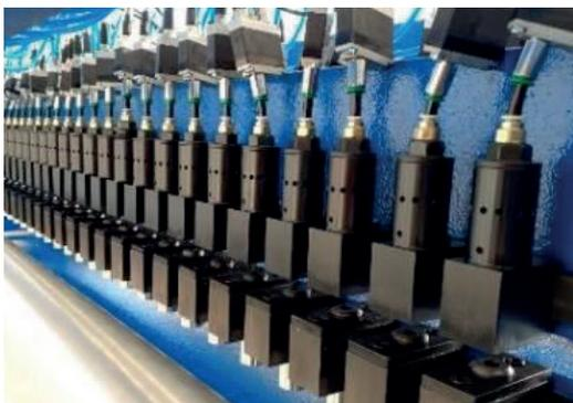
Diese schnelle pneumatische Perforiermaschine dient zum Stanzen von **Makro-Löchern** mit verschiedenen Durchmessern und Formen auf **Material in Bewegung** (wie **neutrale** oder **gedruckte** Plastikfolie). Das Modell PU 32 soll in bestehende Maschinen wie z.B. Rollenschneider, Extruder, Schweißmaschine, Beutemaschine und so weiter integriert werden.
